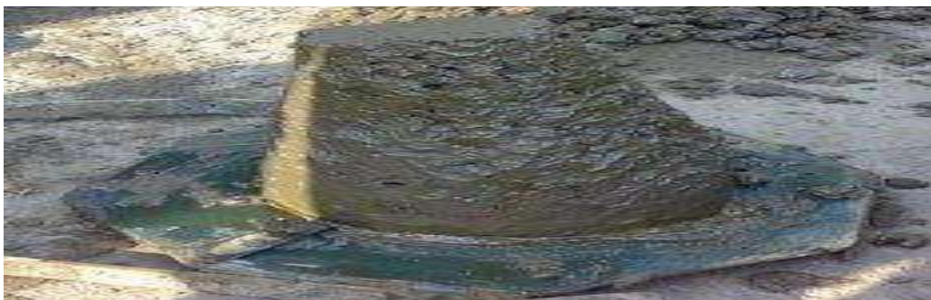
Fig.: Slump test
